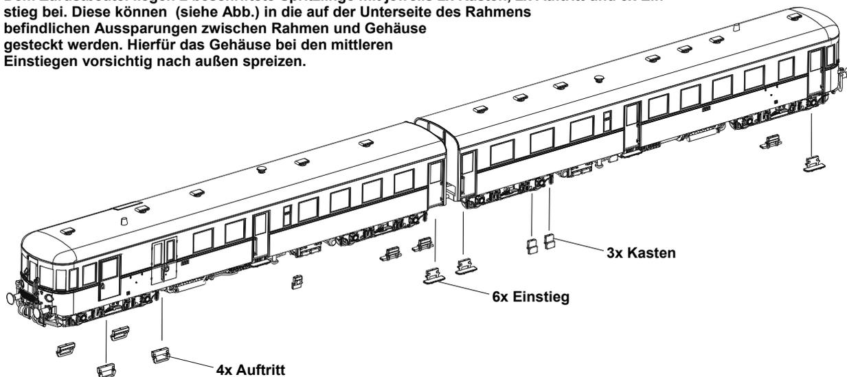
Zum Einsetzen von Figuren können die aufgerasteten Dächer abgenommen werden. Zum Anheben der Beleuchtungsplatine sind die Montageelemente, siehe Art.-Nr. 138380 in der Explosionsdarstellung, zu entfernen.
