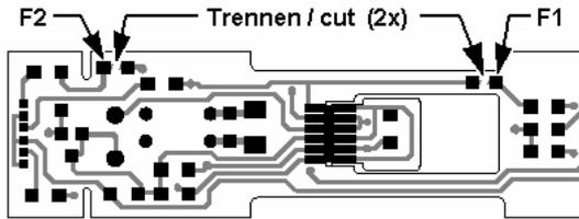
Die Zusatzfunktionen werden an die mit F1 und F2 bezeichneten Löt pads angeschlossen.
