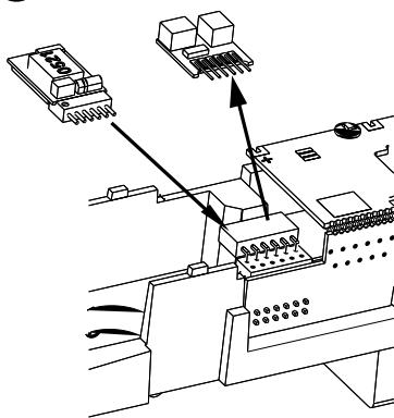
**(DE)** Zum Einbau eines Decoders nach NEM 651 S klein wird nur der Entstörsatz abgezogen. Danach kann ein Decoder nach NEM 651 S klein eingesetzt werden. Hierfür empfehlen wir den Decoder von Uhlenbrock (TILLIG Art.-Nr. 66032).
