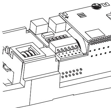
**(DE)** Für eine Digitalisierung gibt es im Modell eine PluX12-Schnittstelle. Wir empfehlen die Verwendung eines Decoders PluX12 von Uhlenbrock (TILLIG Art.-Nr. 66035). Zum Einbau des Decoders ist das Oberteil entsprechend der Anleitung auf Seite 1 abzunehmen. Quer in der Rahmenaußsparung befindet sich die Decoderschnittstelle.
