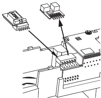
**(DE)** Zum Einbau eines Decoders nach NEM 651 S klein wird nur der Entstörsatz abgezogen. Danach kann ein Decoder nach NEM 651 S klein eingesetzt werden. Hierfür empfehlen wir den Decoder von Uhlenbrock (TILLIG Art.-Nr. 66032).
