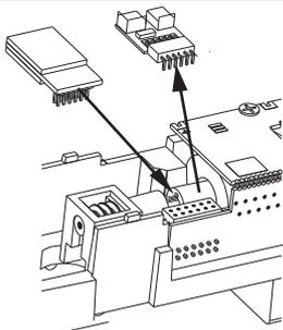
Zum Einbau eines PluX12 Decoders nach NEM 658 wird der Entstörsatz mit dem Adapterleiterplatte abgezogen. Danach kann ein PluX12 Decoder eingesteckt werden.
