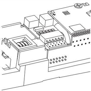
Für eine Digitalisierung gibt es im Modell eine PluX12 Schnittstelle. Wir empfehlen die Verwendung eines Decoders PluX12 von Uhlenbrock (TILLIG Art.-Nr. 66024). Zum Einbau des Decoders ist das Oberteil entsprechend der obigen Anleitung abzunehmen. Seitlich in der Rahmenaussparung befindet sich die Decoderschnittstelle.
