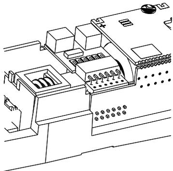
(DE) Für eine Digitalisierung gibt es im Modell eine PluX12-Schnittstelle. Wir empfehlen die Verwendung eines Decoders PluX12 von Uhlenbrock (TILLIG Art.-Nr. 66035). Zum Einbau des Decoders ist das Oberteil entsprechend der Anleitung auf Seite 1 abzunehmen. Seitlich in der Rahmenseitwand befindet sich die Decoderschnittstelle.
