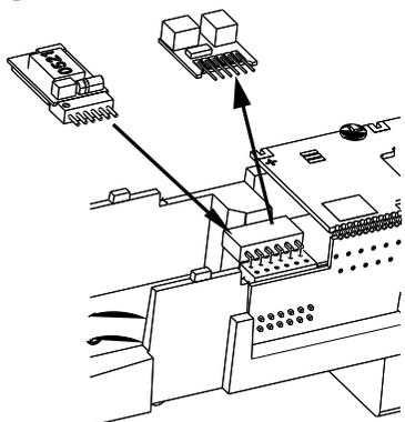
(DE) Zum Einbau eines Decoders nach NEM 651 S klein wird nur der Entstörsatz abgezogen. Danach kann ein Decoder nach NEM 651 S klein eingesteckt werden. Hierfür empfehlen wir den Decoder von Uhlenbrock (TILLIG Art.-Nr. 66032).
