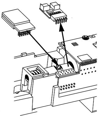
(DE) Zum Einbau eines PluX12-Decoders nach NEM 658 wird der Entstörsatz mit dem Adapterleiterplatte abgezogen. Danach kann ein PluX12-Decoder eingesteckt werden.
