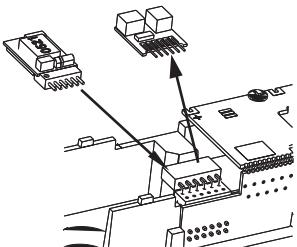
**(DE)** Zum Einbau eines Plux12-Decoders nach NEM 651 S klein wird der Entstörsatz abgezogen. Danach kann ein Decoder nach NEM 651 S klein eingesteckt werden. Hierfür empfehlen wir den Decoder von Uhlenbrock (TILLIG Art.-Nr.: 66032).
