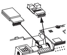
**(DE)** Zum Einbau eines Plux12-Decoders nach NEM 658 wird der Entstörsatz mit dem Adapterleiterplatte abgezogen. Danach kann ein Plux12-Decoder eingesteckt werden.
