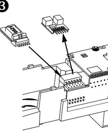
**(DE)** Zum Einbau eines Decoders nach NEM 651 S klein wird nur der Entstörersatz abgezogen. Danach kann ein Decoder nach NEM 651 S klein eingesteckt werden. Hierfür empfehlen wir den Decoder von Uhlenbrock (TILLIG Art.-Nr. 66032).
