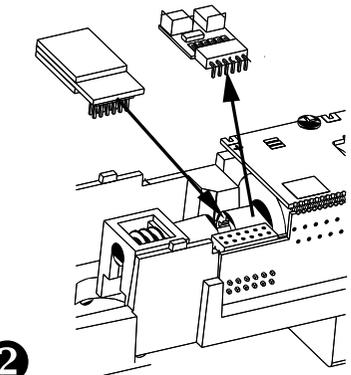
**(DE)** Zum Einbau eines PluX12-Decoders nach NEM 658 wird der Entstörersatz mit dem Adapterleiterplatte abgezogen. Danach kann ein PluX12-Decoder eingesteckt werden.
