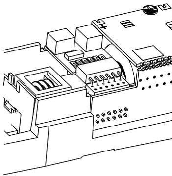
**(DE)** Für eine Digitalisierung gibt es im Modell eine PluX12-Schnittstelle. Wir empfehlen die Verwendung eines Decoders PluX12 von Uhlenbrock (TILLIG Art.-Nr. 66035). Zum Einbau des Decoders ist das Oberteil entsprechend der Anleitung auf Seite 1 abzunehmen. Seitlich in der Rahmenseinbaueinheit befindet sich die Decoderschnittstelle.
