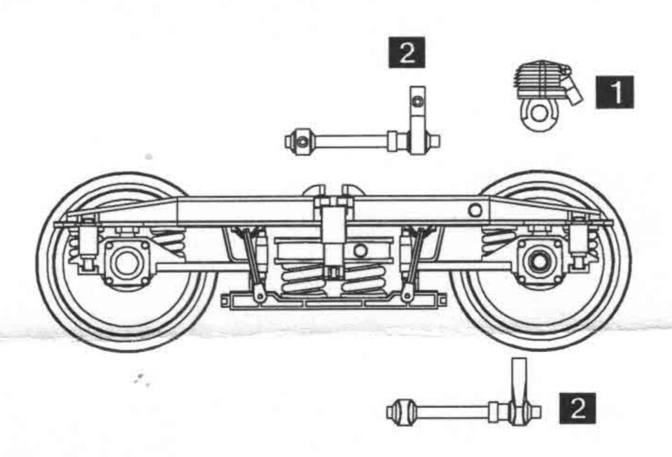
Drehgestell mit Achsgenerator und Dämpfer für Geschwindigkeiten ≥ 140 km/h
