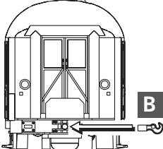
(DE) Drehgestell ohne Lichtmaschine mit Achslagerdeckel
