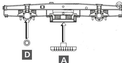
(DE) Drehgestell mit Achsgenerator und Dämpfer für Geschwindigkeiten > 140 km/h
