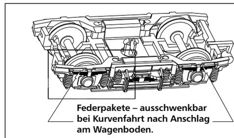
Federpakete – ausschwenkbar bei Kurvenfahrt nach Anschlag am Wagenboden.
