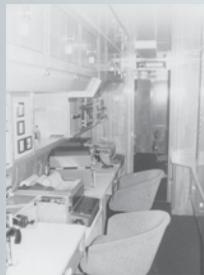
Im Wagen waren ein Senderaum mit zwei Kurzwellensendern, ein Funkbetriebsabteil mit Depeschenschreibmaschinen und Lochstreifensendern als Fernschreibausrüstung und ein Chiffrierabteil angeordnet.
