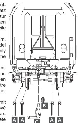
(PL) Na modelu prze-widziano montaż dekodera. W tym celu model dysponuje złączem Next 18 zgodnym z NEM 662. Odpowiednie złącze dostępne jest po zdjęciu budki maszynisty. Należy wtedy zdjąć zespół przeciwickłoceniowy i zastąpić go odpowiednim dekoderem.
