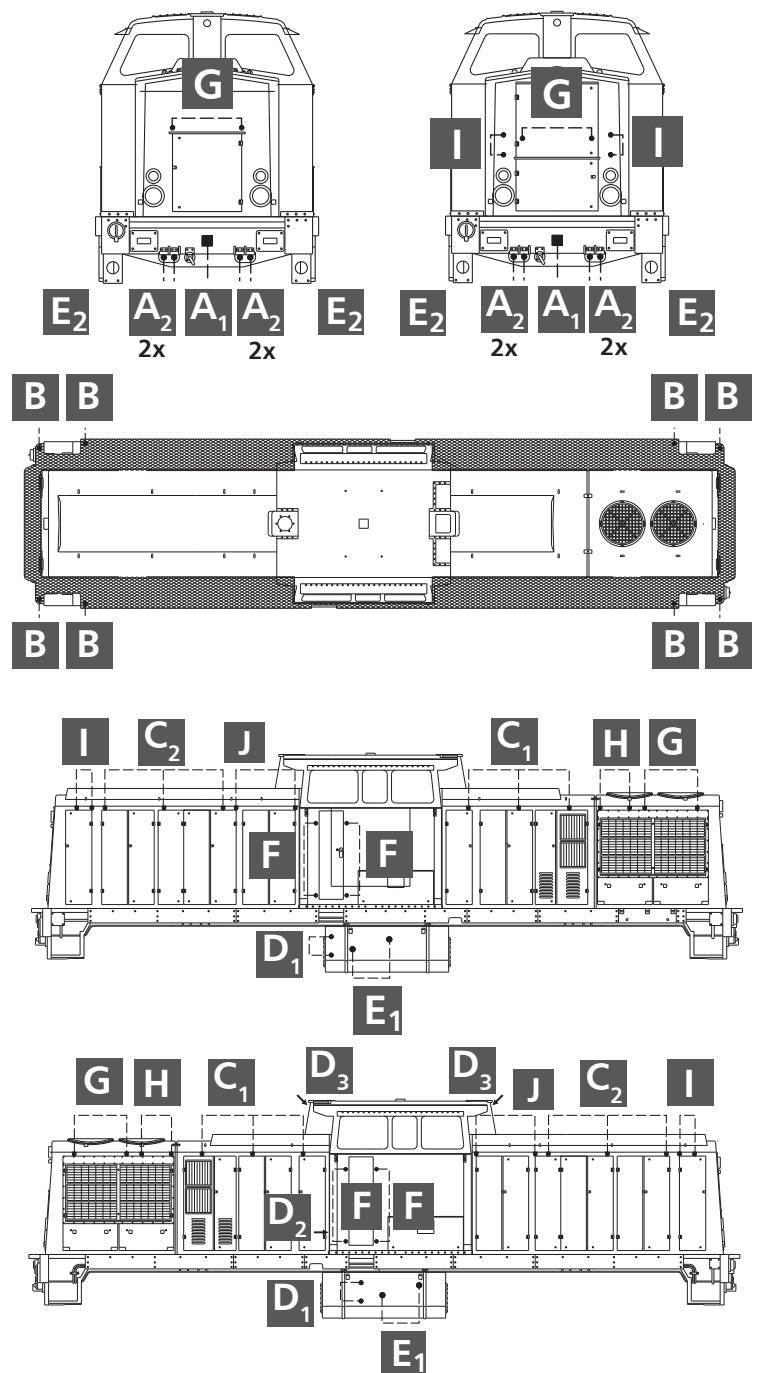
(CZ) Model je určen pro montáž dekodéru. K tomu účelu je model vybaven rozhraním Next 18 dle NEM 662. Toto rozhraní je přístupné po sejmání kabiny strojvedoucího. Zde stáhněte odrůšovací sadu a nahradte ji příslušným dekodérem.
