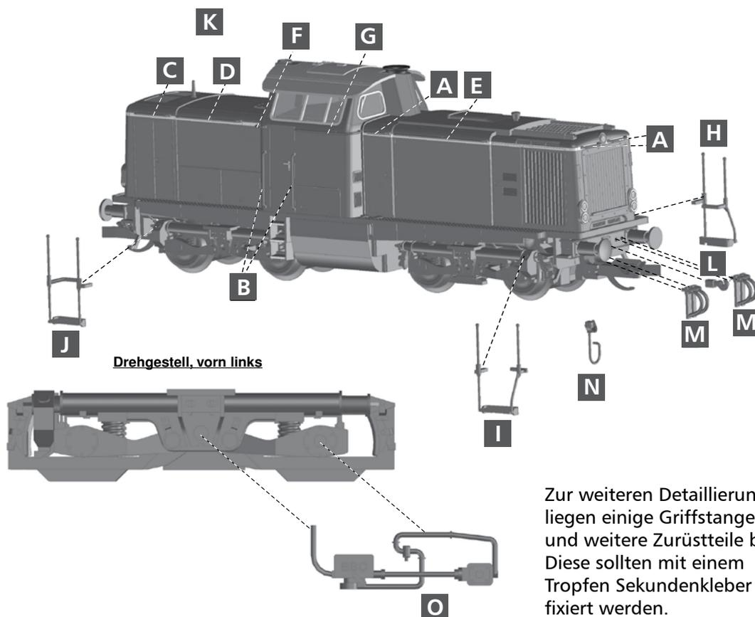
Zur weiteren Detaillierung liegen einige Griffstangen und weitere Zurüstteile bei. Diese sollten mit einem Tropfen Sekundenkleber fixiert werden.
